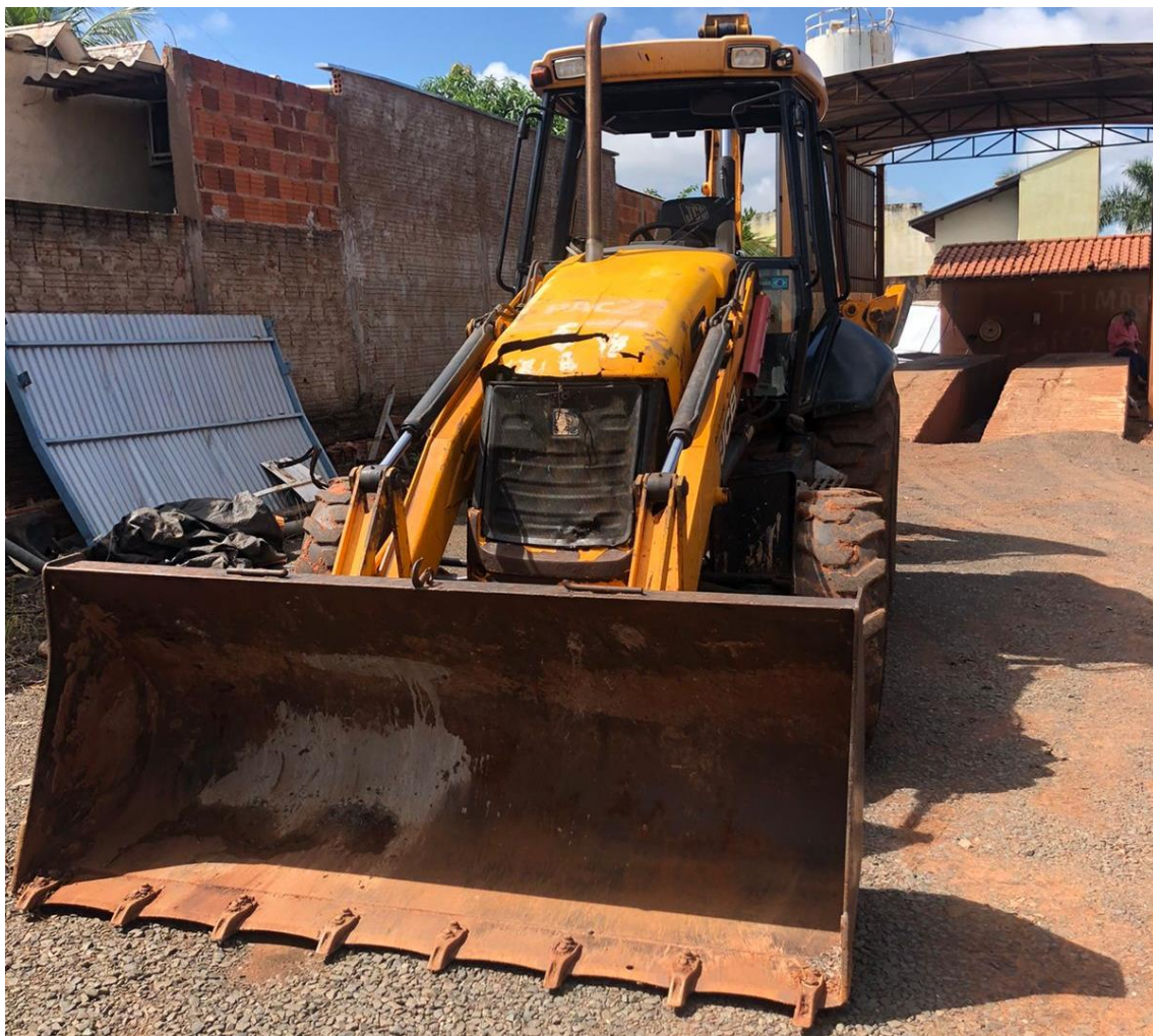
Foto 5: Veículo Retroescavadeira utilizado para coleta de resíduos da construção civil.
