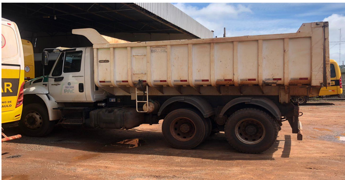
Foto 6: Veículo Caminhão Caçamba utilizado para transporte de resíduos da construção civil.
